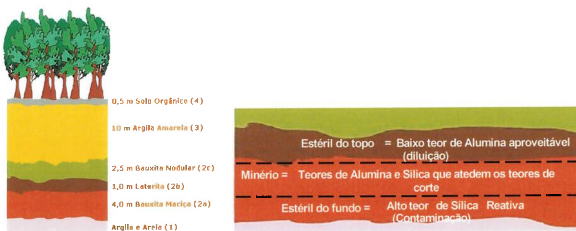
Figura 12: a) Litologia típica de um depósito tabular de bauxita no norte do Brasil e b) definição das superfícies de contato capeamento-minério e minério-estéril (Sousa, 2004).
